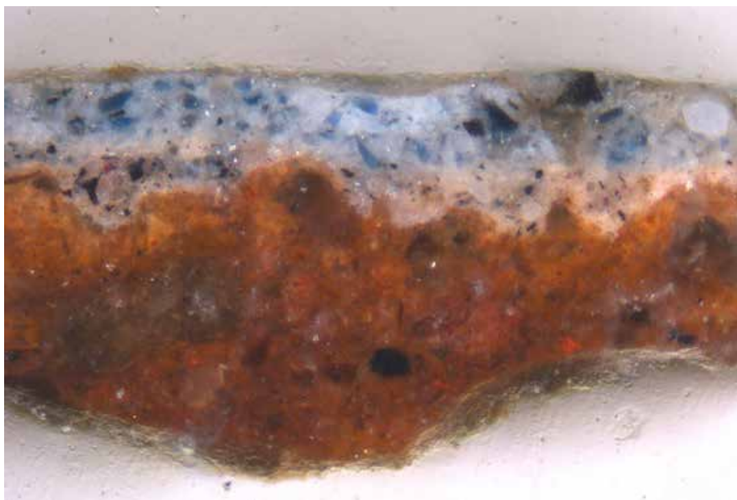
Fig. 5A. – Sezione stratigrafica di un campione costituito da preparazione e pellicola pittorica osservata al microscopio ottico.
